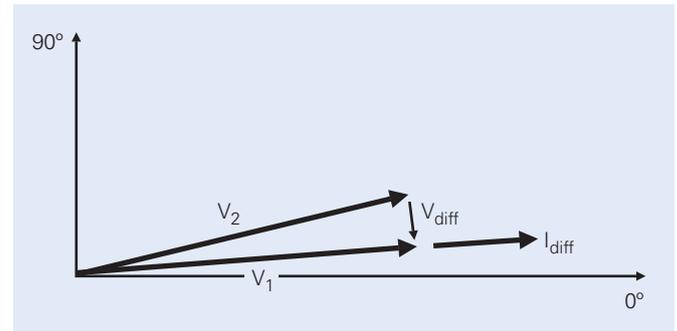
**Abb. 3:** Eine Phasendifferenz zwischen den Ausgangsspannungen zweier parallelgeschalteter USV-Anlagen ( $V_1$  und  $V_2$ ) verursacht einen Stromfluss zwischen den USV-Einheiten und stört damit die Lastaufteilung.
