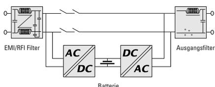
**Passive Offline Standby Technologie** ist die am häufigsten verwendete USV-Technologie zum Schutz von PCs vor Netzausfällen sowie Unter- und Überspannungen.
