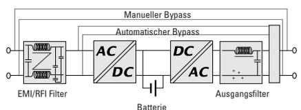
**Die Online-Doppelwandler Technologie** stellt die Grundlage für USV-Anlagen dar, die einen lückenlosen Spannungsschutz für unternehmenswichtige Systeme gewährleisten und diese vor allen Spannungsproblemen schützen sollen: Netzausfälle, Unter- bzw. Überspannungen, Transienten, hochfrequentes Rauschen, Frequenzschwankungen und Oberschwingungen. Durch diese Technologie wird eine ständige Sicherung der Stromversorgung unabhängig von der Netzqualität gewährleistet.
