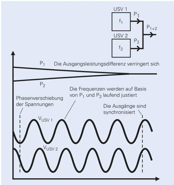
**Abb. 2:** Eine gleichmäßige Lastaufteilung wird durch die Variation der Ausgangsfrequenzen erreicht; dies resultiert auf einer Reduzierung der Phasendifferenz zwischen den parallelgeschalteten USVs auf Null Grad.
